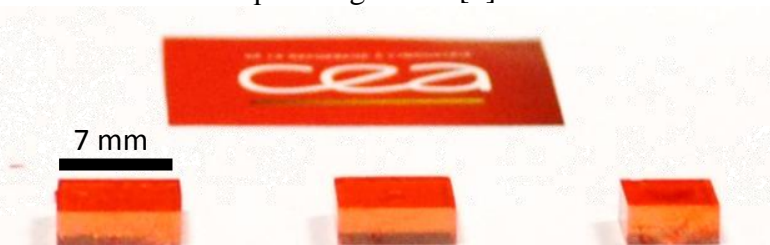
Figure 1 : Image de monocristaux de \text{CH}_3\text{NH}_3\text{PbBr}_3 fabriqués par la méthode de croissance cristalline par montée en température
